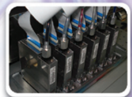
Cabezales japoneses originales SII con control automático de voltaje
